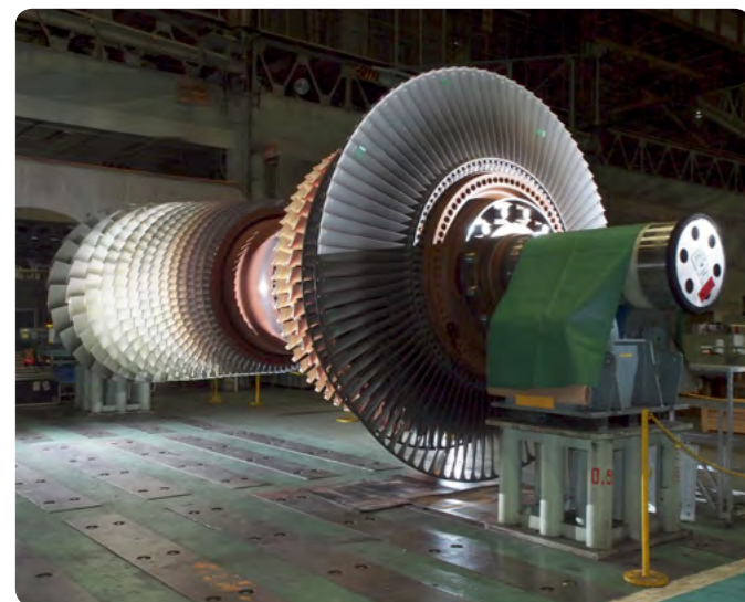
1500℃級ガスタービンのローター 写真提供：新エネルギー・産業技術総合開発機構(NEDO)
