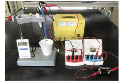
※その際、水をよくかき混ぜ、全体が均一になるようにして温度を測定する。また、温度計のセンサー部分が抵抗器に接触しない（近づきすぎない）ようにする。
