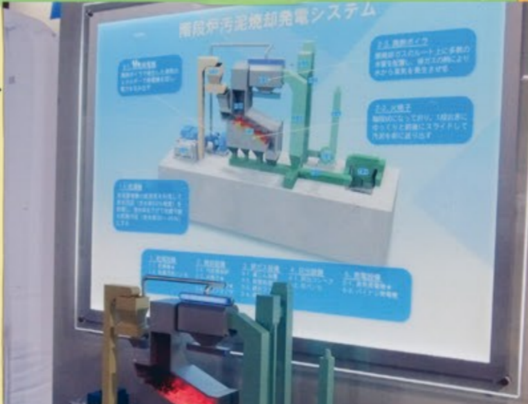
階段汚泥焼却発電システム
