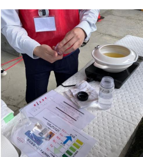
苛性ソーダとメタノールを混ぜ合わせる工程。
