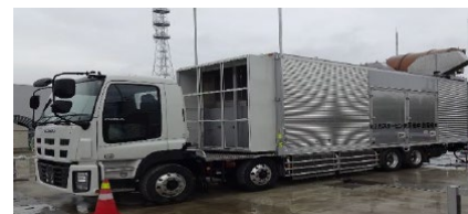
ガスタービン発電機車
