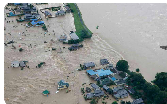
●大洪水によるひがい 大雨で決壊した鬼怒川の堤防（2015年9月、茨城県常総市）
