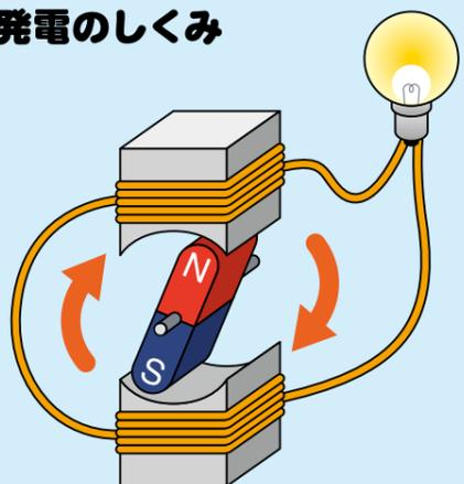
コイルの中で磁石を回すと、コイルに電気がおこる。これが発電のしくみである。実際の発電所では、蒸気や流れる水の流れでタービン（羽根車）や水車を回し、そこに繋がれている発電機で電気が作られる。
