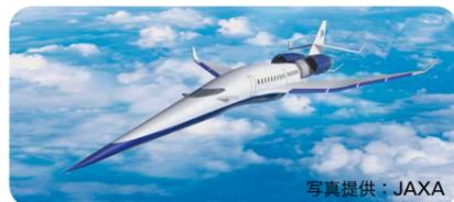
超音速旅客機(宇宙航空研究開発機構(JAXA))音より速く飛ぶ超音速旅客機の研究開発が進んでいる。燃料に使用する液体水素は、同じ質量のジェット燃料の3倍ものエネルギーがあり、二酸化炭素も排出しない。また、ターボエンジンの冷却にも利用され、大きな推力を出せる。
