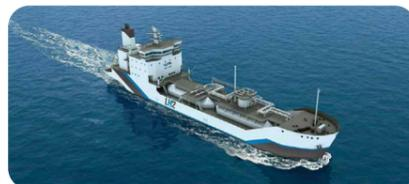
大規模水素海上輸送 海外の安価な未利用エネルギーから水素を製造し、日本に輸送する国際的な開発プロジェクトが進められている。日本-ブルネイ間(2020年)、日本-オーストラリア間(2021年)で輸送試験を実施し、その後の実用化をめざしている。
